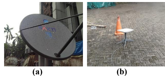
Gambar 1. Antena yang digunakan untuk pengujian (a) Antena HTS 1,2 Meter, (b) Antena Starlink Standar V3 Gen 2
